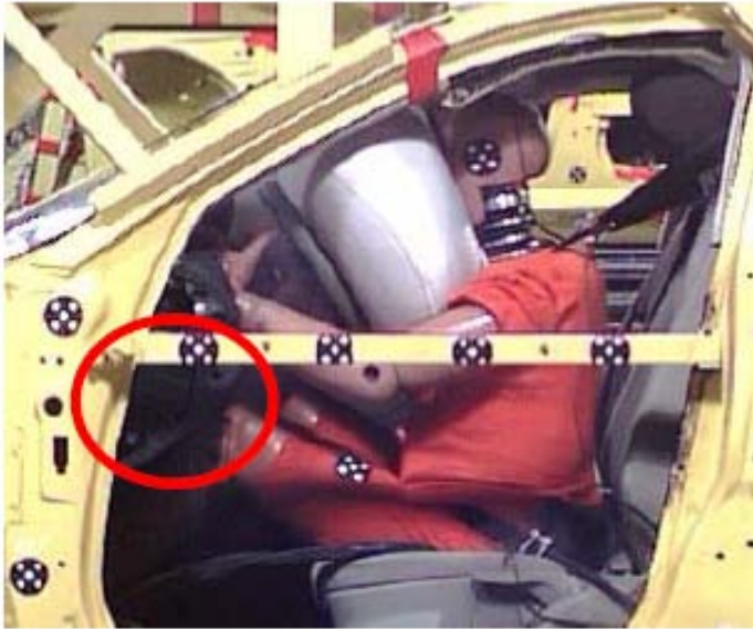
Fig. 8. Contactul genunchilor șoferului cu planșa de bord
