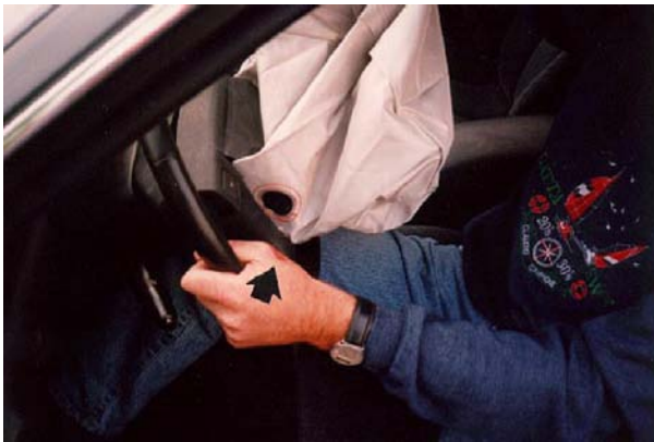
Fig. 6. Arsuri superficiale datorită exploziei air - bagului
