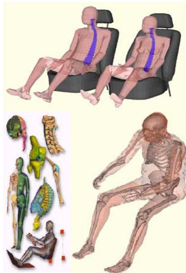
Fig. 27. Modelul manechinului Dummy Hybrid III 50%
