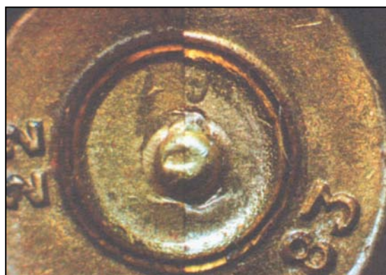
Fig. 7 Analiza comparativă a striațiilor de pe suprafața glonțului
