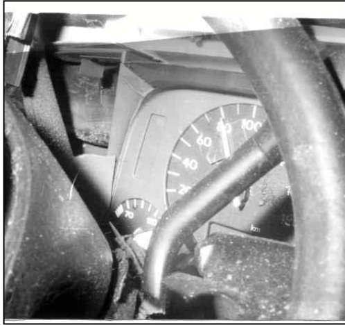
Fig. 2 Acul vitezometrului blocat în urma unui impact frontal.
