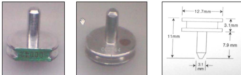
Fig. 12. „Stub” – uri de prelevare
