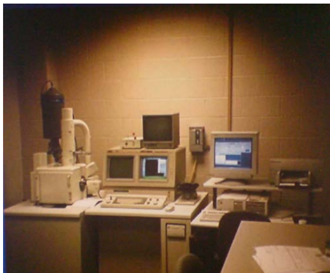
Fig. 13. Microscop electronic (SEM) cu analizor EDX
